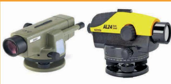
Les Niveaux AL24 et ses accessoires et celui de précision LEICA NAK2
