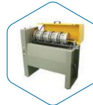
Machine d'essai d'abrasion (Micro Deval)
